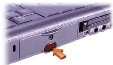
Il sensore a infrarossi (IR) del computer consente di trasferire file dal proprio computer a un'altra periferica compatibile a infrarossi senza dover usare connessioni via cavo. Quando si riceve il computer, il sensore a infrarossi è disattivato. Per [attivare il sensore a infrarossi](#), usare il programma di configurazione del sistema.
